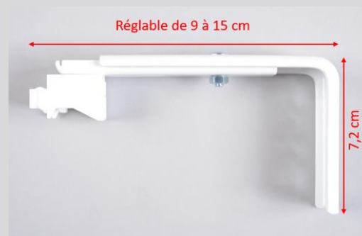
Détail et dimensions du support
